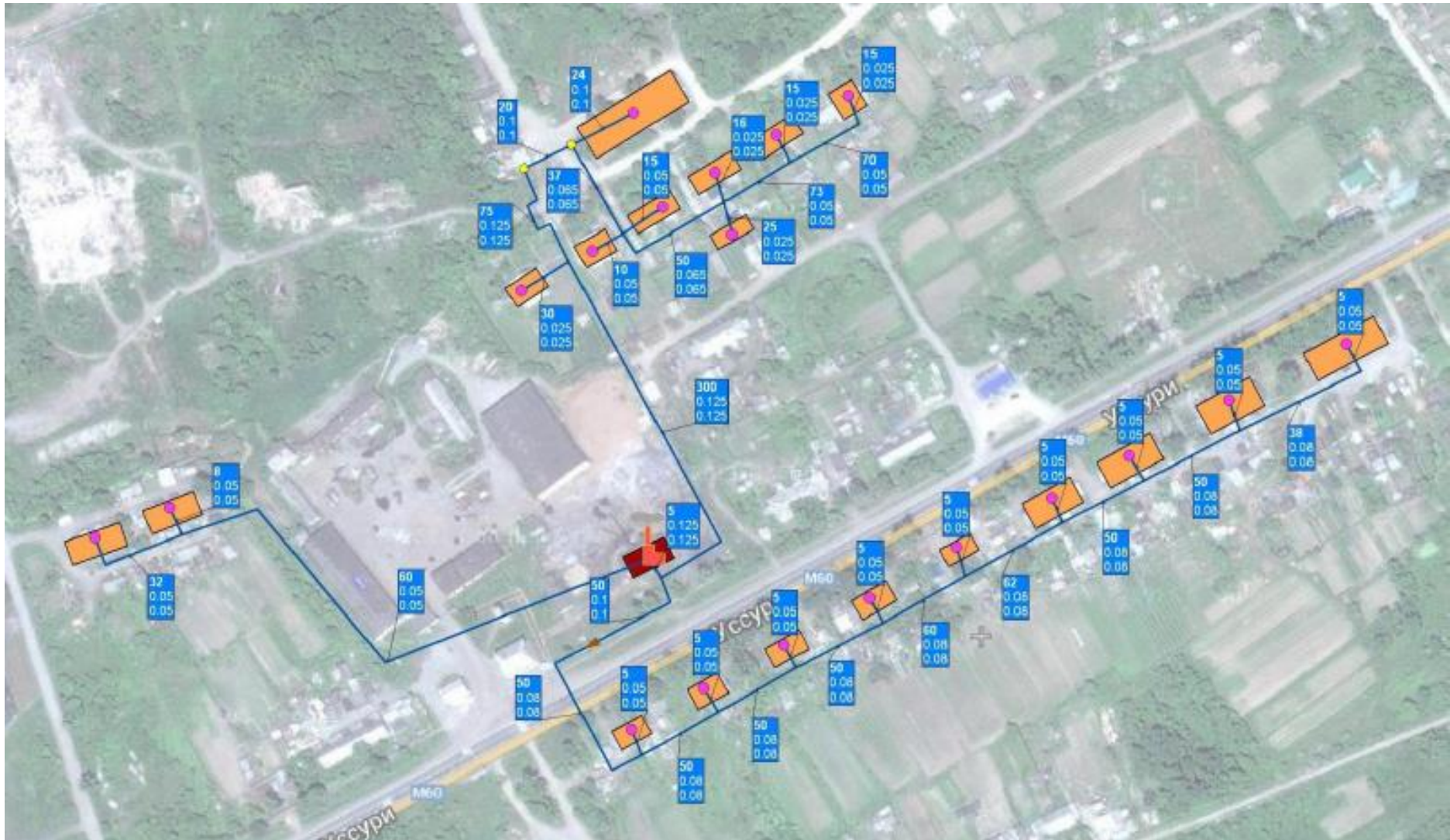
Рис. 2.7 – Схема тепловых сетей котельной «ДРСУ»
