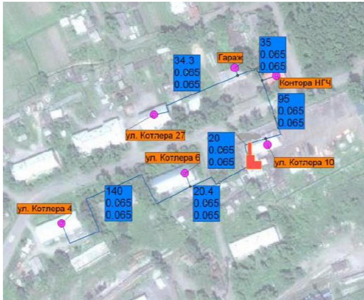
Рис. 2.10 – Схема тепловых сетей котельной «НГЧ»
