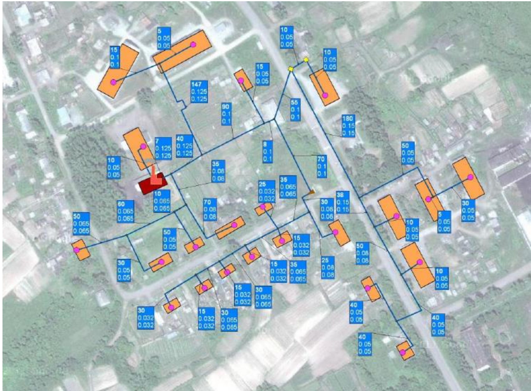
Рис. 2.6 – Схема тепловых сетей котельной «Кирпичный завод»
