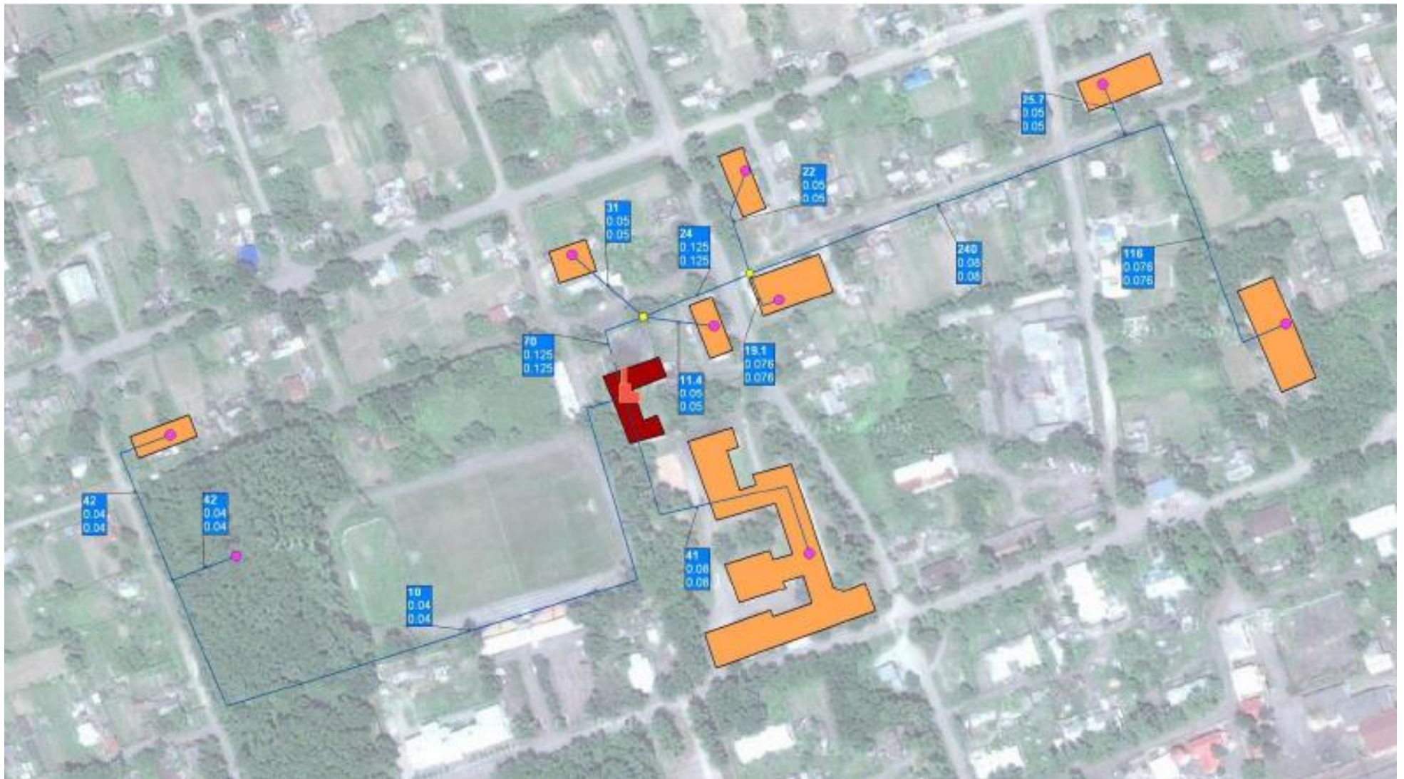
Рис. 2.2 – Схема тепловых сетей котельной «Школа №20»
