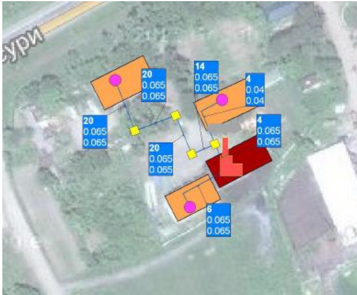
Рис. 2.9 – Схема тепловых сетей котельной «Ростелеком»
